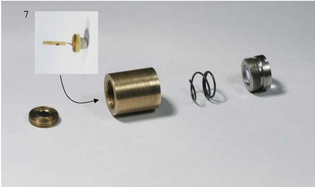
4. Надеть на торчащую ножку оставшуюся часть SMA разъема и прикрутить всё к задней крышке винтиками M2.
